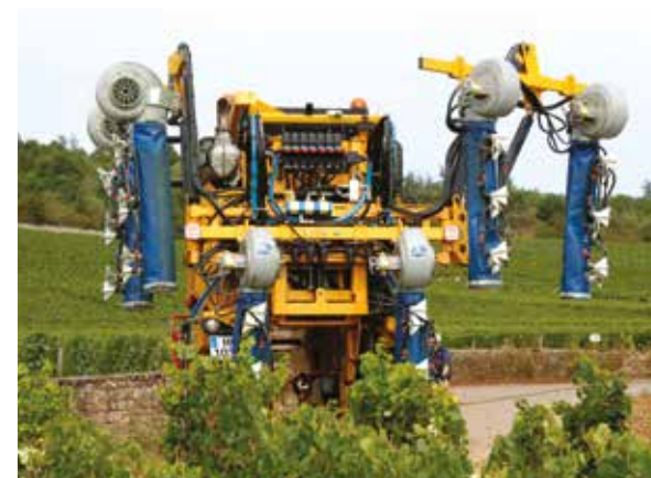
Relevage des rampes
