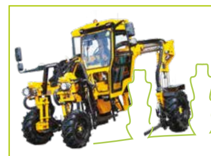
Correction de dévers - Voie variable
