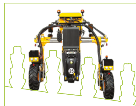
Correction de dévers
